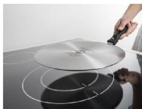
Например, FRABOSK: Данный диск выполнен из высококачественной нержавеющей ферро-магнитной стали, идеальной для использования на индукционных плитах последнего поколения. Он **позволяет Вам использовать посуду из стекла, керамики или меди на индукционных плитах**. Толщина трехслойной сэндвич-конструкции адаптера 3мм, что намного больше толщины индукционного диска любой сковороды.
