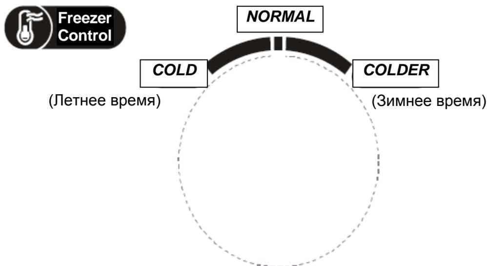
В положении «COLDER» (Очень холодно) температура замораживания относительно низкая, в положении «COLD» (Холодно) температура замораживания относительно высокая, поэтому регулятор обычно устанавливают в положение «NORMAL» (Нормально).
