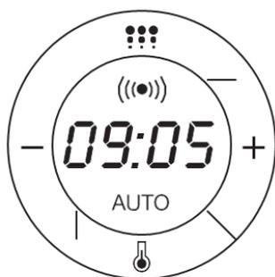
Индикатор •••: загорается при выборе функции пиролизической очистки.
