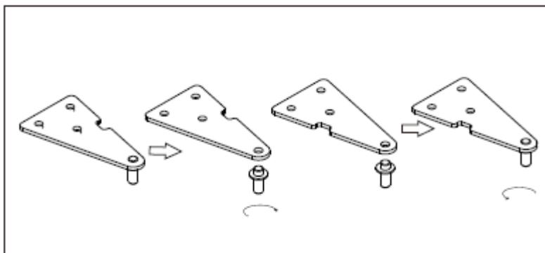
7. Установите верхнюю дверь, а затем верхнюю петлю с левой стороны. Перед окончательной затяжкой верхней петли убедитесь, что верхняя дверь выровнена по горизонтали и вертикали таким образом, чтобы уплотнители были закрыты со всех сторон. При необходимости, для затягивания петли используйте гаечный ключ.
