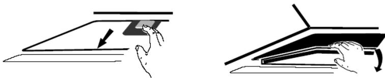
Установите угольный фильтр на моторе и поверните по часовой стрелке для закрепления. Тоже самое сделайте с другой стороны мотора.
