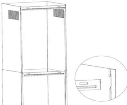
Просверлите 2 отверстия по 8 мм. Закрепите короб с помощью двух винтов.
