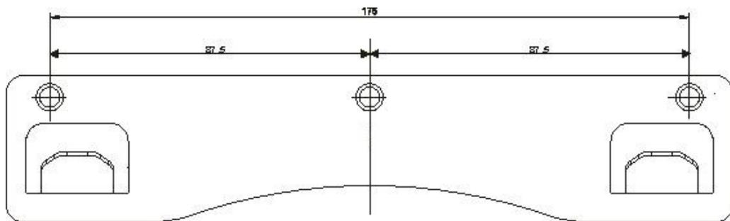
Подвесьте вытяжку на закрепленный кронштейн.
